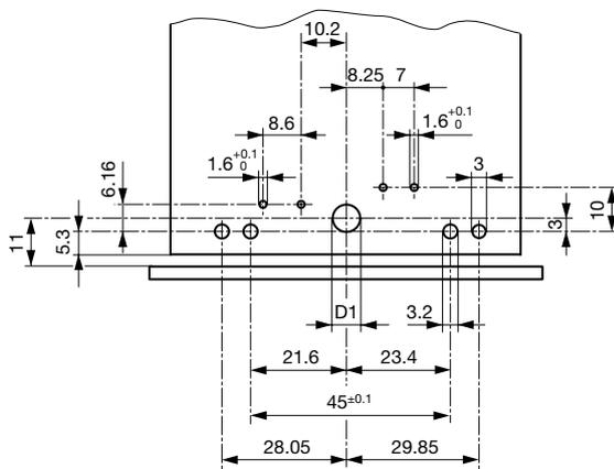
Befestigung von unten auf Print oder Gehäuseboden
