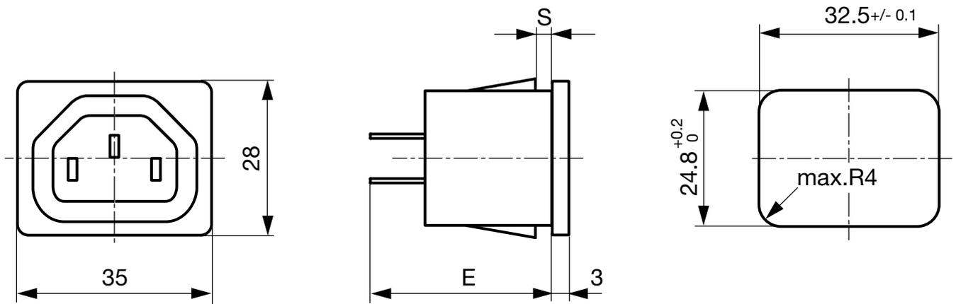
E: Lötanschlüsse: 24.1 mm
