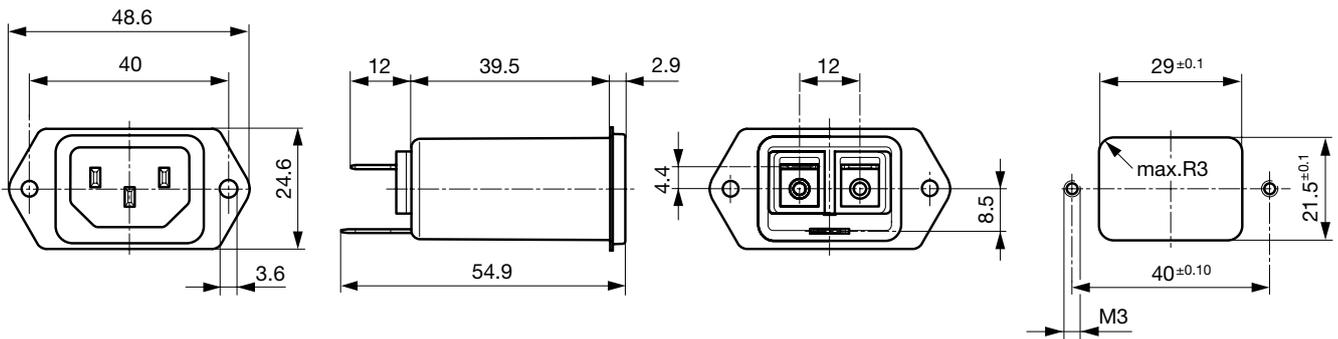
Rückseitige Montage mit M3 Schrauben (Plattenausschnitt für Rückseiten Montage)
